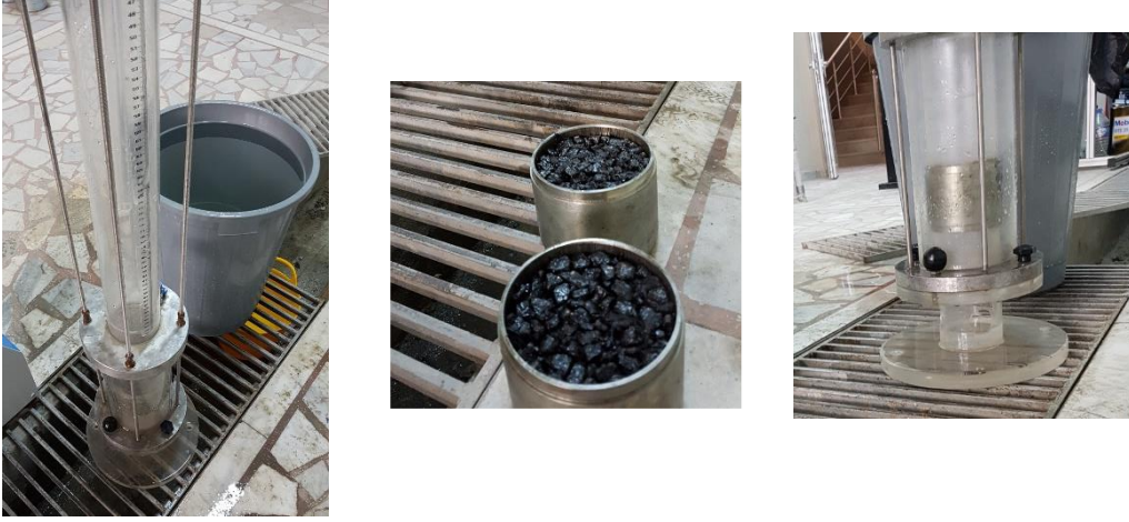
Şekil 6. Laboratuvarında kullanılan permeabilite deney düzeneği
