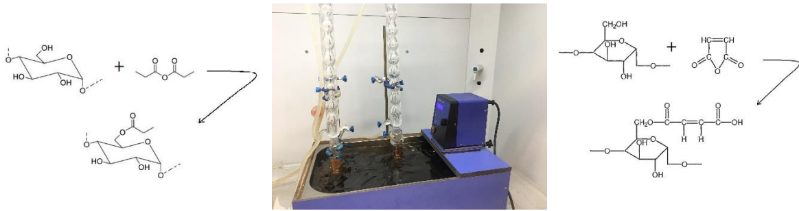
Şekil 2.1. Kaplamaların propiyonik anhidrit (solda) ve maleik anhidrit (sağda) ile sıcak yağ banyosunda kimyasal modifikasyonu
