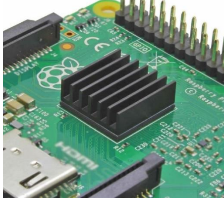
Şekil 2. Tasarlanan ısı giderinin elektronik devre üzerindeki görünümü
