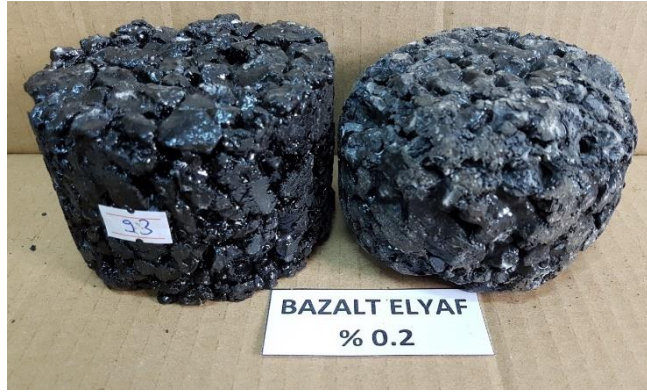
Şekil 8. Cantabro aşınma deneyi öncesinde ve sonrasında numuneler
