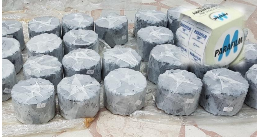
Şekil 4. Boşluk analizleri için sıkıştırılmış numunelerin parafilm ile kaplanması
